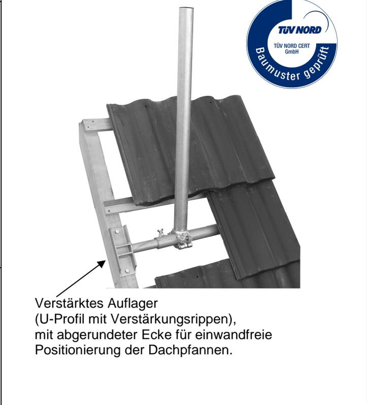
Verstärktes Auflager (U-Profil mit Verstärkungsrippen), mit abgerundeter Ecke für einwandfreie Positionierung der Dachpfannen.
