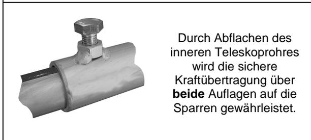
Durch Abflachen des inneren Teleskoprohres wird die sichere Kraftübertragung über **beide** Auflagen auf die Sparren gewährleistet.
